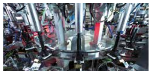
Einer der wichtigsten Schritte im Produktionsablauf: die Endprüfung der Zündspule.
