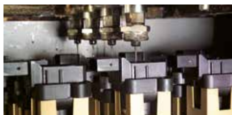
Per Vakuumverguss wird der Sekundärdraht in Vergießharz eingebettet.
