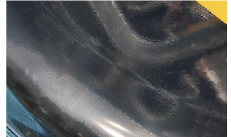
Kondensat im E-10-Ansatz: Bei den Proben mit Konservierungsmitteln trat dies nicht auf. Der Vergaser war allerdings frei von Korrosion
