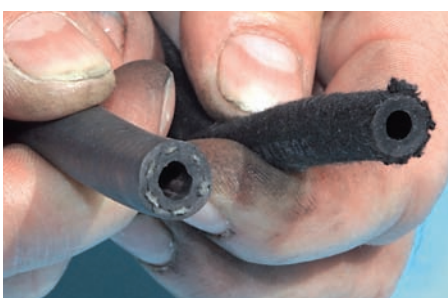
Der moderne Vollgummischlauch (l.) sollte mittlerweile erste Wahl sein, er ist auf heutige Kraftstoffe zumindest besser abgestimmt als der Textilmantel-Klassiker
