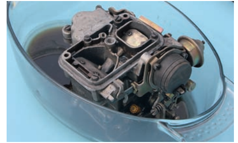
Nicht alle Vergaser sehen so gut aus wie dieser: Im korrosionsverdächtigen E10 hielten sie sich am besten – damit haben wir nicht gerechnet
