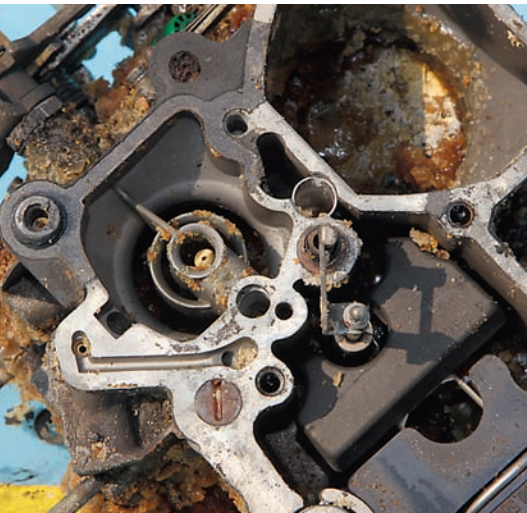
Der totale Zerfall von E 85 überrascht nicht: Konservierende Additive sind nur im Otto-Kraftstoff enthalten. Sie sind aber durch das Mischungsverhältnis 85 zu 15 fast unwirksam
