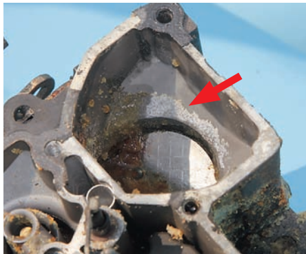
Die Zerfallsprodukte dürften vom Ethanol stammen, denn sie greifen das Metall an: Die schützende Patina auf der Oberfläche ist unter den krümeligen Resten bereits verloren (Pfeil)
