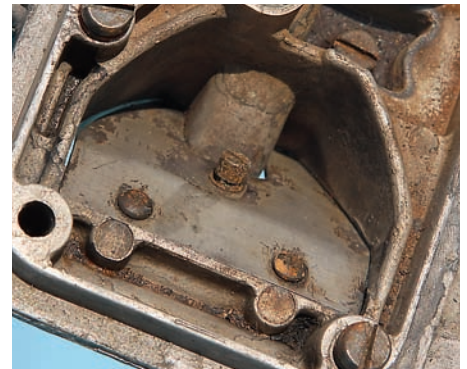
Korrosion im E-5-Vergaser: Die hierfür verantwortliche Entmischung von Ethanol und Otto-Kraftstoff ist gerade bei relativ niedrigem Alkoholanteil unter zehn Prozent ein Problem
