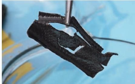
Ich war eine Gummileitung: Ausgerechnet im E-5-Kraftstoff wurden alle Benzinschläuche völlig zerstört – das haben wir so nicht erwartet
