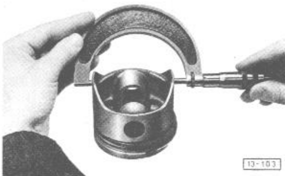
Abb. 6 Kolben Ø prüfen
