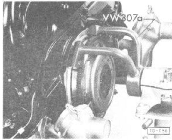
Für die Durchführung von Montagearbeiten ist der Motor mit dem Halter VW 307 a an einem Montagestand zu befestigen.
