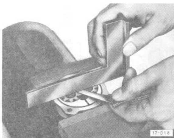
Abb. 2 Ölpumpe – Axialspiel prüfen max. 0,1 mm
