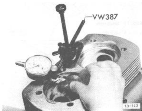
Abb. 15 Ventileführungen prüfen Kippspiel max. 0,8 mm
