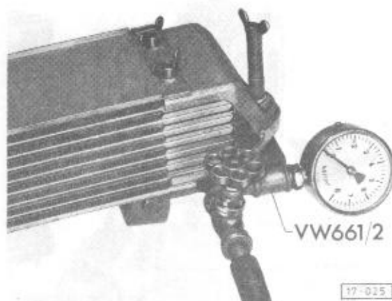
Abb. 4 Ölkühler auf Dichtigkeit prüfen
