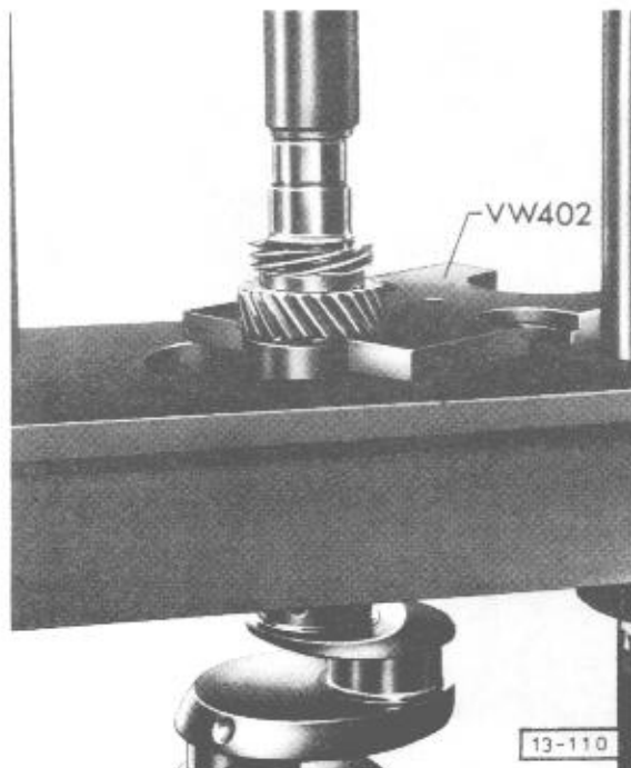
Abb. 7 Kurbelwellenrad mit Zündverteilerantriebsrad ausbauen
