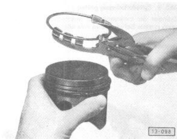
Abb. 1 Kolbenringe aus- und einbauen
