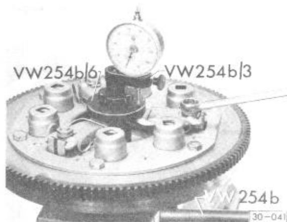
Abb. 6 Druckplatte – Schlag einstellen
