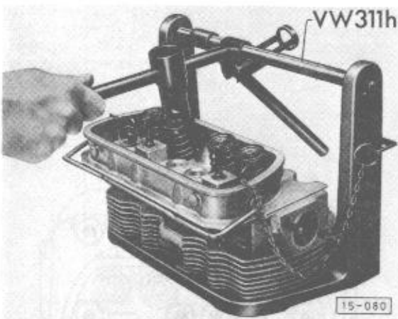
Abb. 5 Ventildfedern aus- und einbauen
