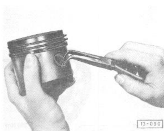
Abb. 5 Sicherungsring aus- und einbauen
