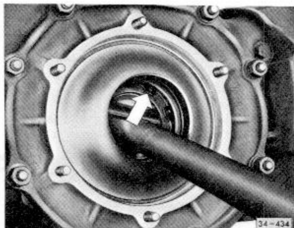
Abb. 4 Sicherungsring (Pfeil) mit Spitzzange (handelsüblich) abnehmen
