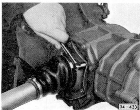
Abb. 3 Lagerdeckel abschrauben und Achsrohr komplett mit Gelenkschutzhülle abnehmen
