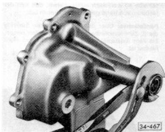
Abb. 1 Lagerbuchse mit Dichtring herausdrehen
