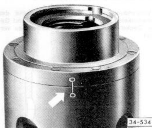
Abb. 3 Kennzeichnung des Deckels zum Gehäuse
