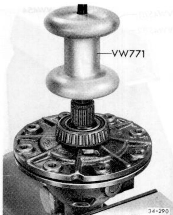
Abb. 3 Deckel vom Ausgleichgetriebegehäuse abziehen
