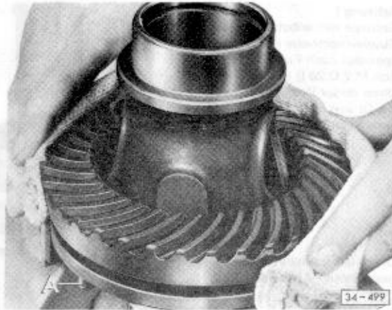
Abb. 3 Tellerrad auf ca. 100° C erwärmen und aufsetzen
