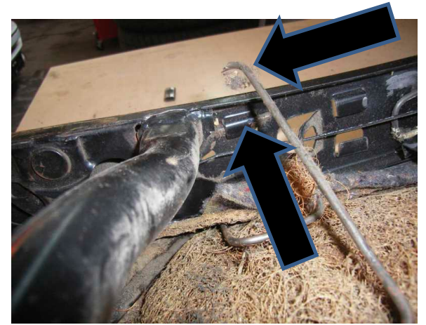
Fahrer- und Beifahrersitz: Leider sind die „Kernbereiche“ in keiner guten Verfassung. Gebrochene Federn, Streben und Trägerelemente. Die Pfeile zeigen hier, welche Teile zusammengehören.
