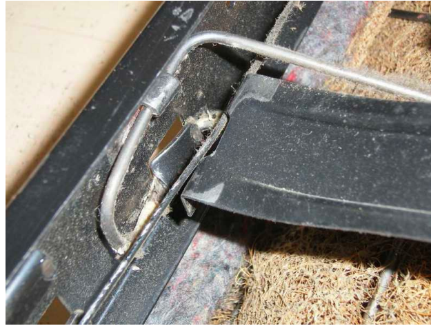
Fahrer- und Beifahrersitz: Leider sind die „Kernbereiche“ in keiner guten Verfassung. Gebrochene Federn, Streben und Trägerelemente. Die Pfeile zeigen hier, welche Teile zusammengehören.
