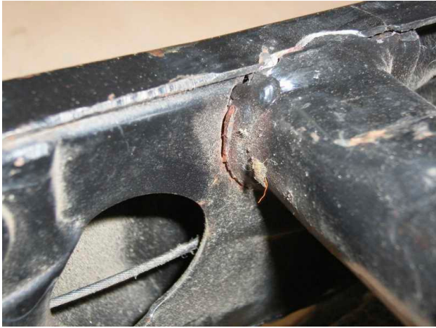
Fahrer- und Beifahrersitz: Leider sind die „Kernbereiche“ in keiner guten Verfassung. Gebrochene Federn, Streben und Trägerelemente. Die Pfeile zeigen hier, welche Teile zusammengehören.
