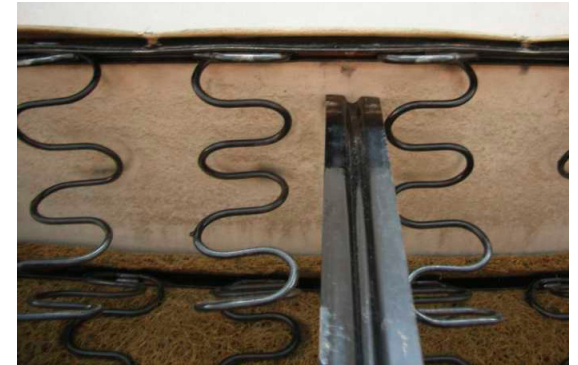
Sitzbank hinten: Der Stoff ist porös durch die UV- Einwirkung, die Federung ist ok, jedoch ist eine Strebe bei der Schweißstelle gebrochen
