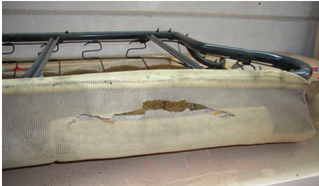
Sitzbank hinten: Der Stoff ist porös durch die UV- Einwirkung, die Federung ist ok, jedoch ist eine Strebe bei der Schweißstelle gebrochen
