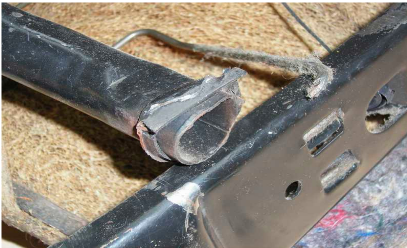
Fahrer- und Beifahrersitz: Leider sind die „Kernbereiche“ in keiner guten Verfassung. Gebrochene Federn, Streben und Trägerelemente. Die Pfeile zeigen hier, welche Teile zusammengehören.
