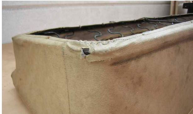
Sitzbank hinten: Der Stoff ist porös durch die UV- Einwirkung, die Federung ist ok, jedoch ist eine Strebe bei der Schweißstelle gebrochen
